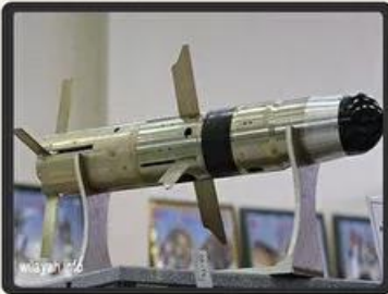
صاروخ دهلاوية جو - أرض موجه بالليزر المدى: 8 كم قوة اختراق: 120 سم
