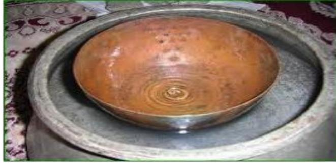
الصورة 7: توضيح التسيرية وهي أداة لقياس توزيع المياه
